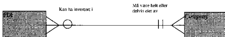
Figur 5.2 Eksempel på notasjon for kobling mellom objektklasser
