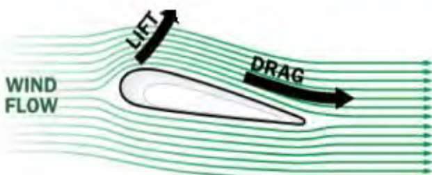
Figur 2: Rotorblad og aerodynamikk. Kilde: (Åtland, et al., 2011a)
