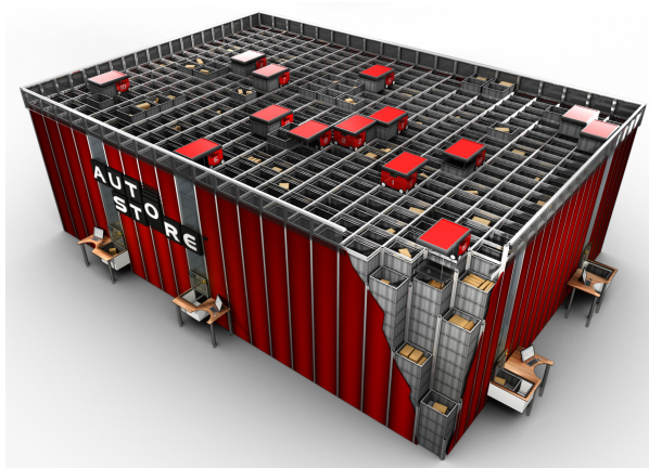
Figur 2.13: Visuell fremstilling av et automatisert kubelager fra AutoStore (EET, 2016).
