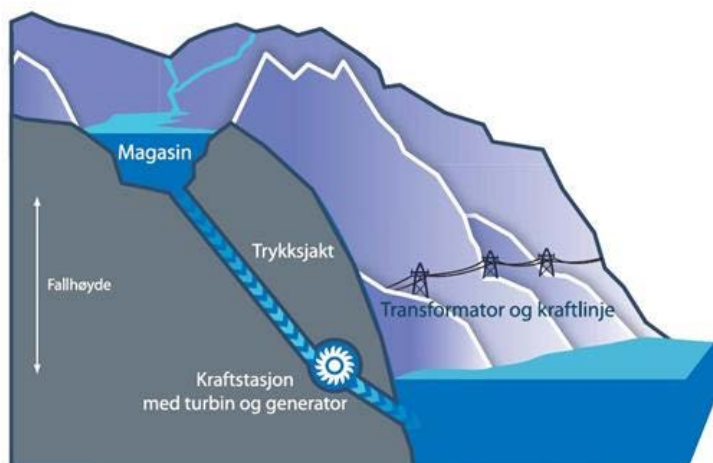
Figur 10: Prinsippskisse av høytrykkskraftverk. Kilde: (fornybar.no).
