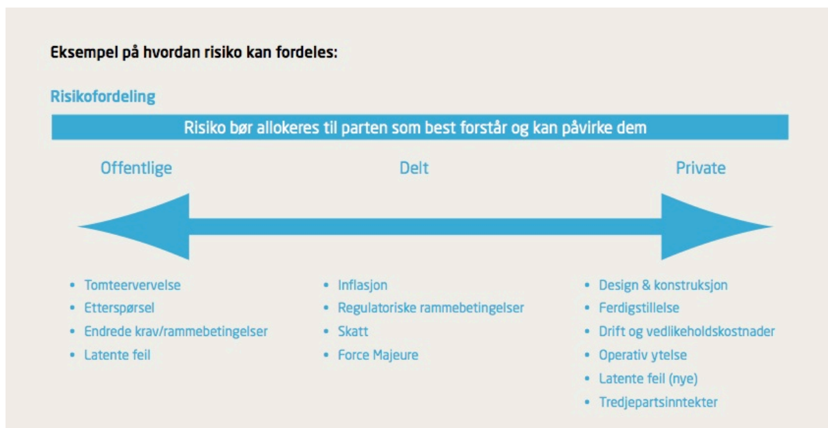
Figur 5.2: Eksempel på risikofordeling ved OPS
