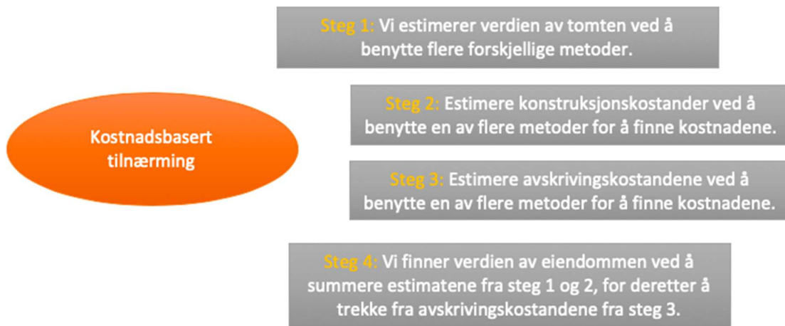
Figur 8: Den kostnadsbaserte tilnærmingen. Figuren er laget med utgangspunkt i informasjonen gjengitt i Fisher & Martin (2008).
